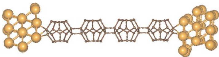
Рис. 1. Цепочка фуллеренов 4C_{20} , закрепленная между двумя полубесконечными электродами Au(111)
