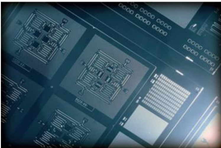
Четырехкубитный сверхпроводниковый квантовый процессор.
