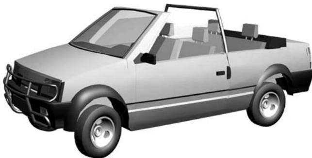
Рис. 1. Автомобиль “Ока” с кузовом “кабриолет”.
