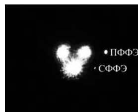
Рис. 1. Фотография “следов” на экране (за образцом), обязанных трём возбуждающим импульсам (более сильные “следы” в центре) и сигналам ПФФЭ и СФФЭ.
