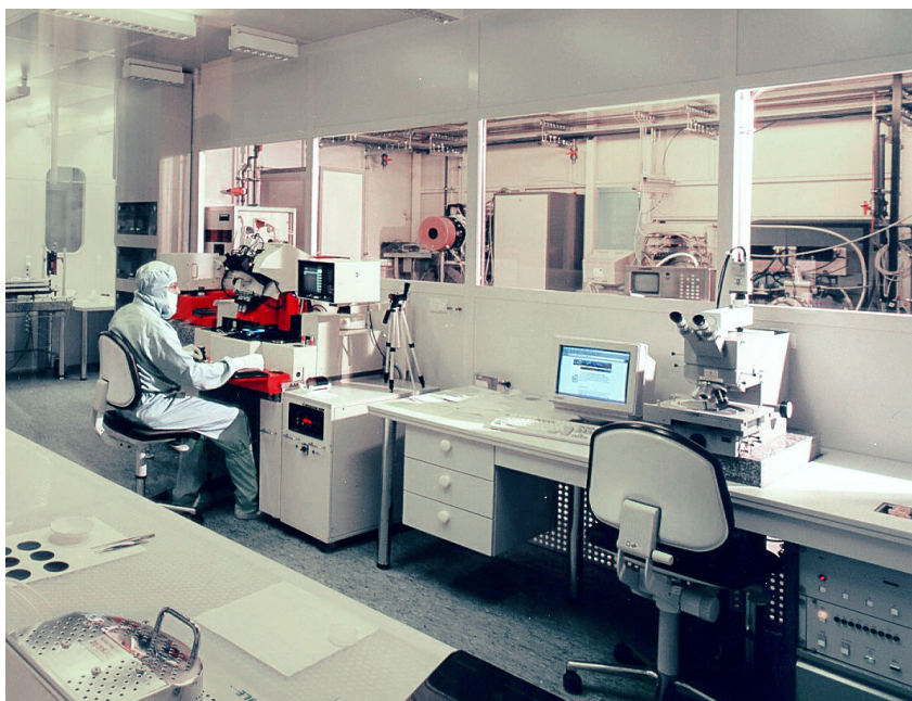
“Стерильная” лаборатория в ИФТТ, где в особо чистых условиях приготавливают наноразмерные “квантовые точки”.
